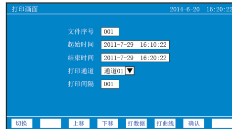
打印画面：可通过设定起始时间和结束时间来打印这段时间的曲线和数据
